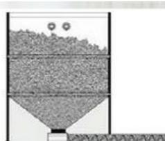
**Formado por:** silo, válvula dosificadora y tornillo sinfín
